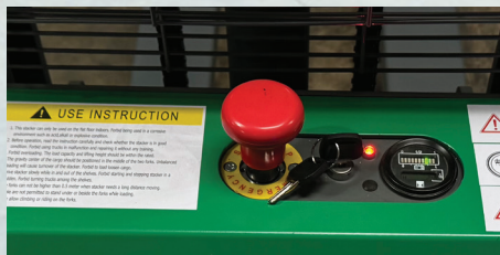
Acil durdurma anahtarı / Emergency stop
