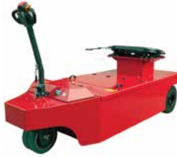
LX-20T RÖMORK ÇEKİCİSİ İTME VE ÇEKME KUVVETİ 20.000kg Art. No: 5700 00 19
