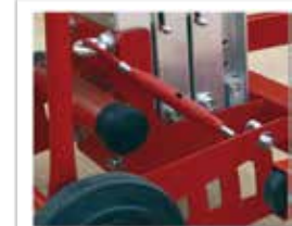
Yatay taşıma işlemi için mast kilitleme sistemi
