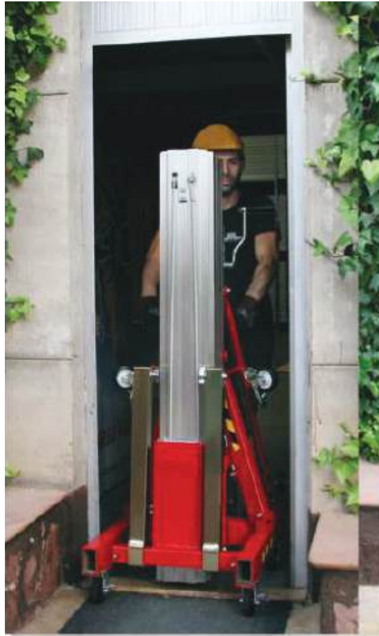
Stabiliteyi artırmak için 2 adet destek profili
