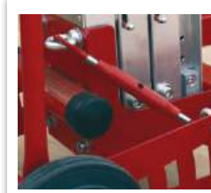
Yatay taşıma işlemi için mast kilitleme sistemi
