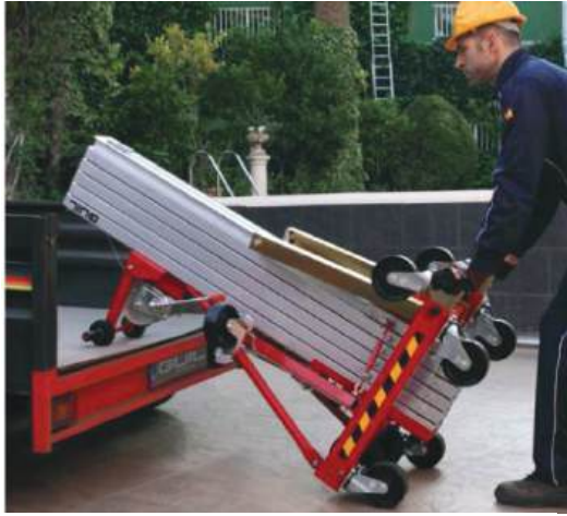
Stabiliteyi artırmak için 2 adet destek profili
